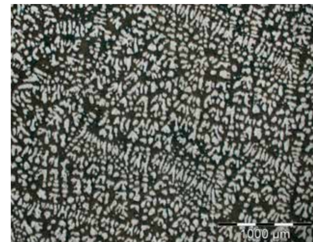
Micrografías a x50μm y 100μm de un material fabricado bajo norma SAC305.
